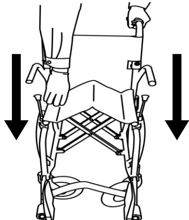
駐車ブレーキをかけた後、片方の押手を持ち、座面の端を図のように手で下へ押し下げます。
