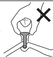
1. ブレーキレバーを伸ばし、駐車用ブレーキをかけ、左右の車輪をロックします。ロック後ブレーキレバーを押し縮めます。
