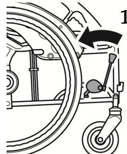
2. フレーム本体のフット・レッグサポート取付パイプにフット・レッグサポート取付樹脂を差し込みスイングアウトレバーを引きながら下ろします。
