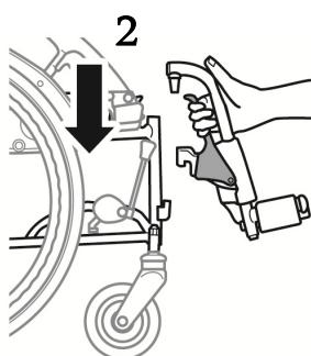
3. 「カチッ」という音がしてスイングアウトスライドピンが差し込み穴に収まり固定されたことを確認して下さい。
