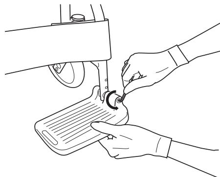
3. フットプレートをレッグパイプの穴に合わせて取り付けボルトで取り付けます。この時、フットプレート内のナットが動かないように注意しながら締め付けてください。
