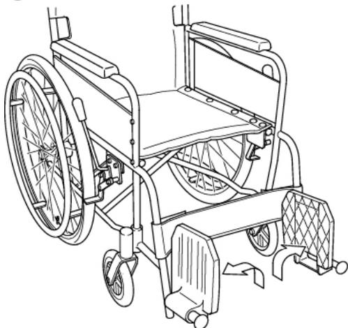
駐車ブレーキをかけ、ステップ板を閉じるように上方へ（矢印の方向へ）跳ね上げます。
