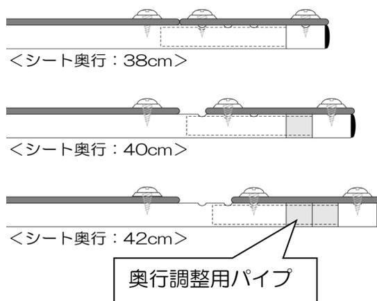
④シートパイプの先端を戻して固定します。
