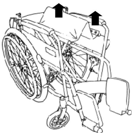
座シートの前方と後方の中央部を同時に持ち上げます。
