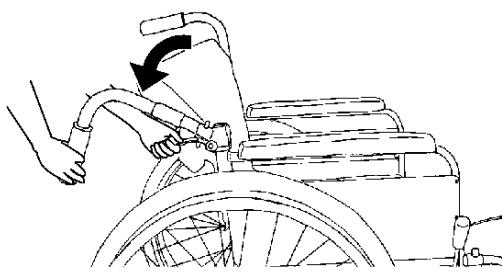
車いすの押手を握り、少し前に押して、一方の手でレバーを引きながら押手を手前に引くようにして折りたたんで下さい。
