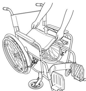
②-3 シートパイプの先端部を抜き取ります。
