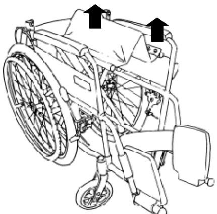
座ベースシートの前方と後方の中央部を同時に持ち上げます。
