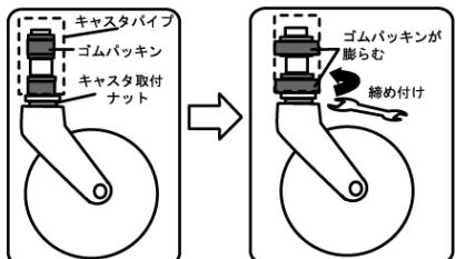
(出荷時には十分に締め付けてありますが、ご使用されている間に振動により緩む場合がありますので、定期的に点検してください。)
