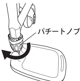
4. 適切な高さになるように、フットプレートを上下に動かします。
