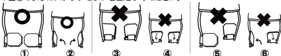
※車いすを折りたたむ時は上図②のようにステップ板を跳ね上げてください。
