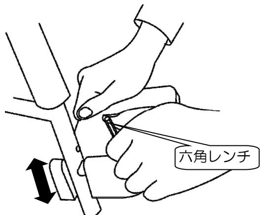
左右に跳ね上げられているステップ板を矢印の向きに下ろしてください。
