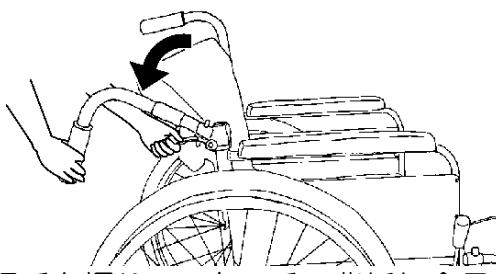
押手を握り、一方の手で背折れ金具のレバーを後方へ引きながら（もしくは前方へ倒しながら）押手を倒します。
