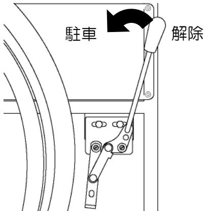
ブレーキレバーを後方に引くとロックし、レバーを前方にすると解除されます。
