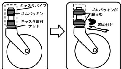
(出荷時には充分に締め付けてありますが、ご使用されている間に振動により緩む場合がありますので、定期的に点検してください。)
