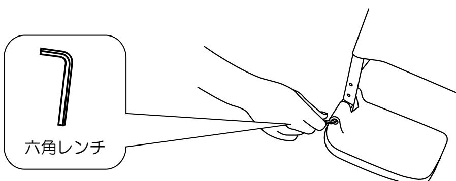
付属品の六角レンチを使ってステップ板を適当な高さの取り付け穴へ合わせた後、ボルトを完全に締めてください。
