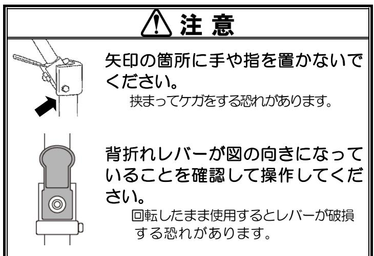
押手を握り、一方の手で背折れ金具のレバーを後方へ引きながら（もしくは前方へ倒しながら）押手を倒します。また、反対側も同様に倒してください。
