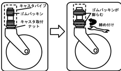
(出荷時には十分に締め付けてありますが、ご使用されている間に振動により緩む場合がありますので、定期的に点検してください。) スパナでキャスト取付ナットを締めると、ゴムパッキンが膨らみ、キャストが固定されます。キャスト取付ナットをしっかりと締めてください。締め付けが弱いとキャストが外れる恐れがあります。
