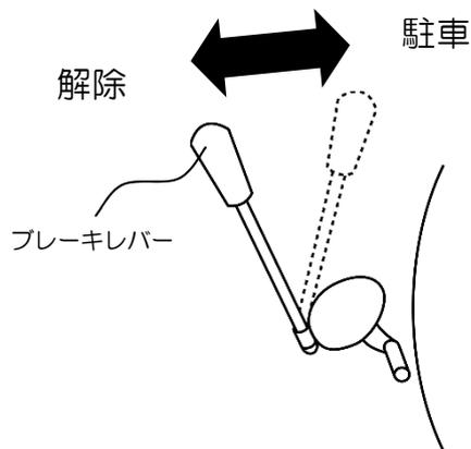
ブレーキレバーを後方に引くとロックし、レバーを前方に押しと解除されます。
