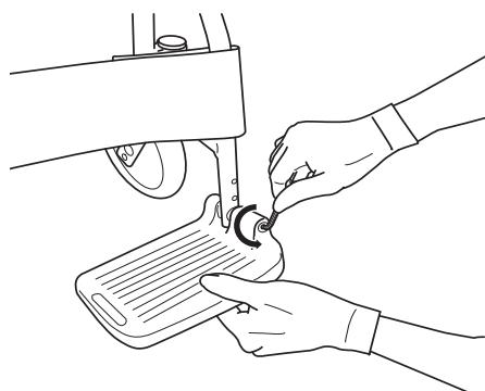
3. フットプレートをレッグパイプの穴に合わせて取り付けボルトで取り付けます。この時、フットプレート内のナットが動かないように、指でやや押し付けながら、締め付けてください。
