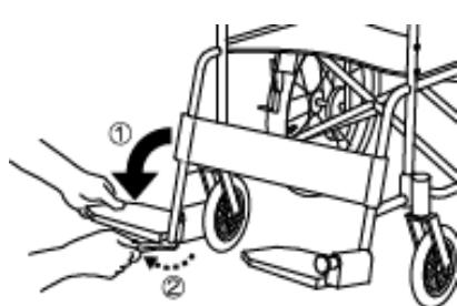
出荷時は、ステップ板(フットサポート)が外側に回転させて折りたたんでありますので、ステップポスト先端のボルトを少し緩め、内側へ回転させます。
