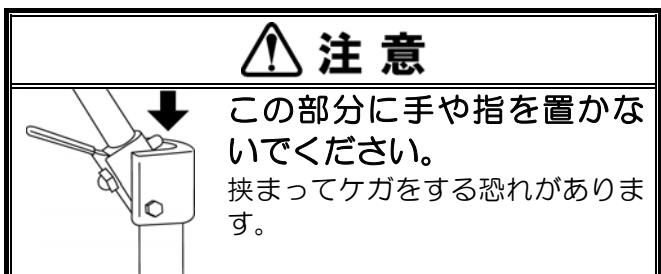
押手(手押しハンドルグリップ)を握り、一方の手で背折れ金具のレバーを後方へ引きながら（もしくは前方へ倒しながら）押手(手押しハンドルグリップ)を倒します。また、反対側も同様に倒してください。
