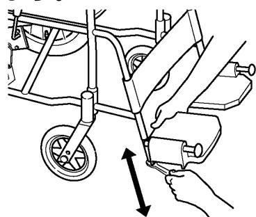
ステップ板(フットサポート)を適当な高さに合わせた後、ボルトを完全に締めてください。
