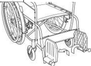
駐車ブレーキをかけ、ステップ板を上方へ（矢印の方向へ）跳ね上げます。
