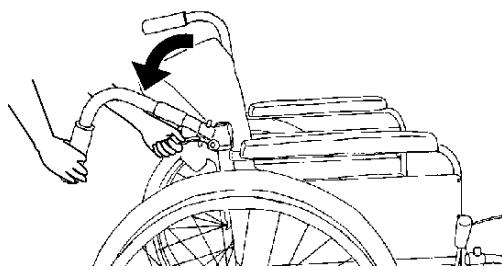
押手を握り、一方の手で背折れ金具のレバーを後方へ引きながら（もしくは前方へ倒しながら）押手を倒します。また、反対側も同様に倒してください。
