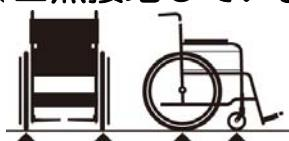
前車輪二輪と後車輪二輪が接地しているかご確認ください。
