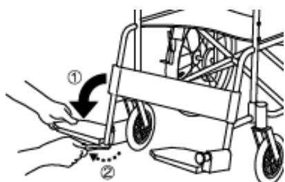
出荷時は、ステップ板が外側に回転させて折りたたんでありますので、ステップポスト先端のボルトを少し緩め、内側へ回転させます。
