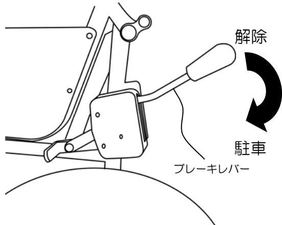
ブレーキレバーを下方に降ろすとロックし、レバーを上方に押し戻すと解除されます。
