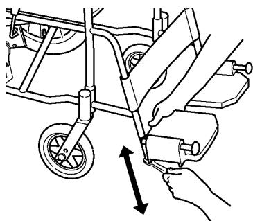
ステップ板を適当な高さに合わせた後、ボルトを完全に締めてください。
