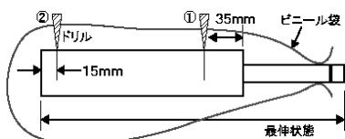
左図の要領で孔を開け、ガス抜きをしてから廃却してください。
