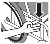
1. 駐車用ブレーキをかけ、左右の車輪をロックします。
