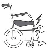
1. 駐車用ブレーキをかけ、左右の車輪をロックします。
