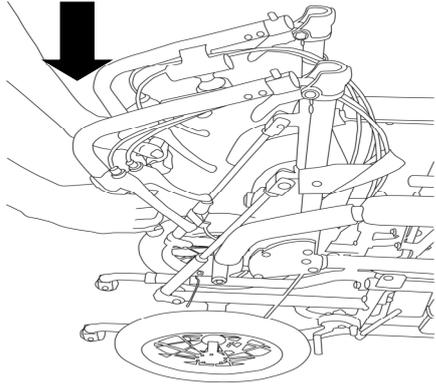
押手を握り、一方の手で背折れ金具のレバーを後方へ引きながら（もしくは前方へ倒しながら）押手を倒します。また、反対側も同様に倒してください。
