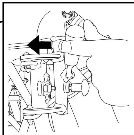
手を添えて脚部を支えながら、もう一方の手でロック解除レバーを背もたれ側に倒します。
