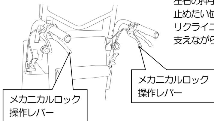
左右の押手と内側のレバーを両方とも握り、後方へ倒します。止めたい位置でレバーを離すと止まります。( 0~80° ) リクライニング操作は、介助者が腕などで車いすをしっかりと支えながら行ってください。
