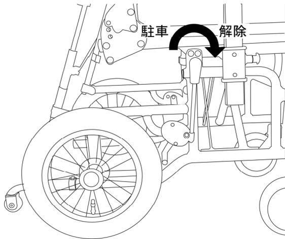
車いす乗降時には、必ず駐車ブレーキをかけて、車いすが固定されていることを確認してください。ブレーキレバーを後方に引くとロックし、レバーを前方にすると解除されます。
