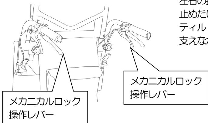
左右の押手と内側のレバーを両方とも握り、後方へ倒します。止めたい位置でレバーを離すと止まります。( 0~35° ) ティルト操作は、介助者が腕などで車いすをしっかりと支えながら行ってください。
