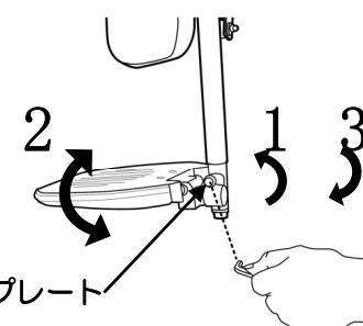
2. フットプレートを回転させ角度を調整します。
