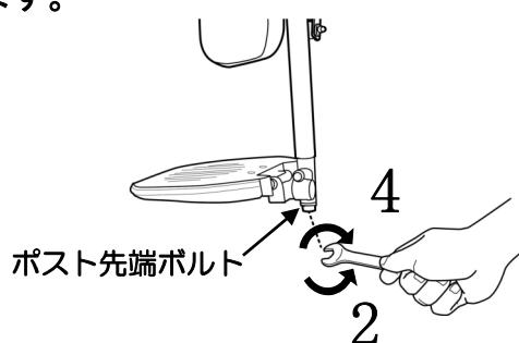
4. ポスト先端ボルトを締付けます。(時計回りでボルトが締まります)
