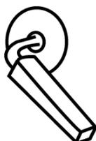
レバーを上へ引き上げると、背もたれの角度が調整できます。反対側にあるネジの位置を変えると背もたれ角度調整範囲を変えることができます。
