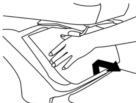
バッテリーを押さえている固定板を外します。
