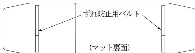
※ マット裏面には、2ヶ所にずれ防止用のベルトが付いています。使用前に、ストレッチャー担架部に固定して使用してください。
