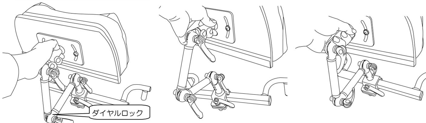
図のように片方の手で枕を支えた状態で、枕部角度調整レバー1~3を解除します。
