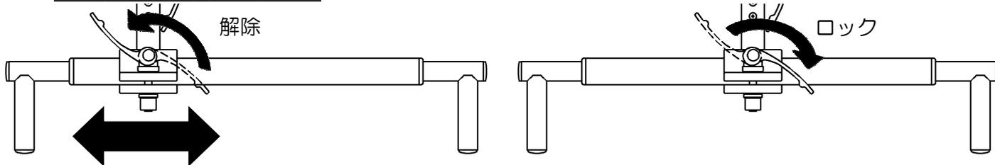
枕部左右調整レバーを解除し、金具をスライドさせて横方向の位置を合わせます。
