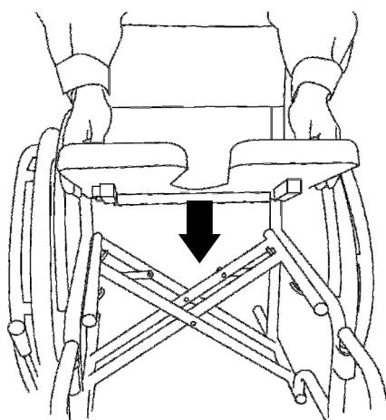
車いすの後方に立ち、片方のフレームを持ち上げて車輪を少し地面から浮かせ、座面端のパイプ部分を手で押し下げます。
