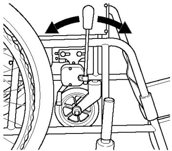
ブレーキレバーを後方に引くとロックし、レバーを前方にすると解除されます。
