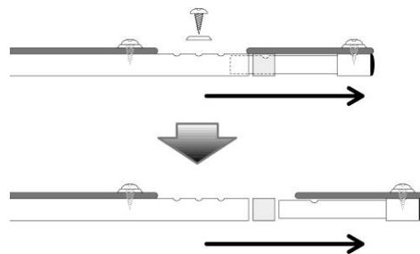
③奥行調整用パイプの入れ込み個数で、シート奥行を調整します。
