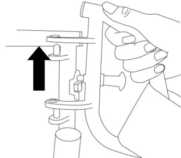
②レバーを引きながら脚部を外側に廻し引き抜きます。
