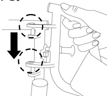
①駐車ブレーキをかけ、外側に廻した状態で脚部を差し込みます。
