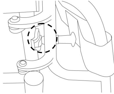
②スイングアウトピンがカチッと音を立てて固定されたことを確認し、足ベルト中央部の面ファスナーをしっかりと貼り合わせます。
