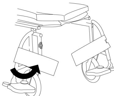
②スイングアウトピンがカチッと音を立てて固定されたことを確認し、足ベルト中央部の面ファスナーをしっかりと貼り合わせます。
