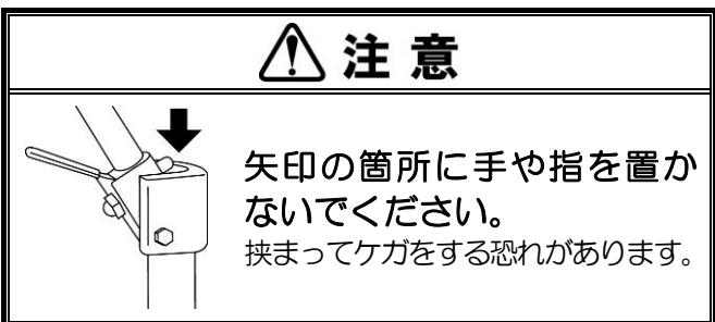
押手を握り、一方の手で背折れ金具のレバーを後方へ引きながら（もしくは前方へ倒しながら）押手を倒します。また、反対側も同様に倒してください。
