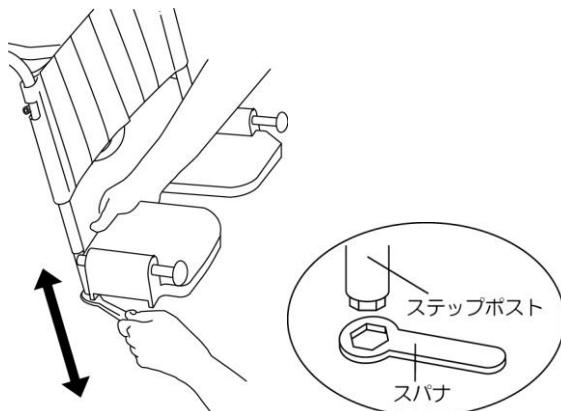
付属品のスパナを使って、ステップポストの先端のボルトを緩め、適当な高さに合わせた後、ボルトを完全に締めてください。
