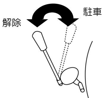
ブレーキレバーを後方に引くとロックし、レバーを前方に倒すと解除されます。
