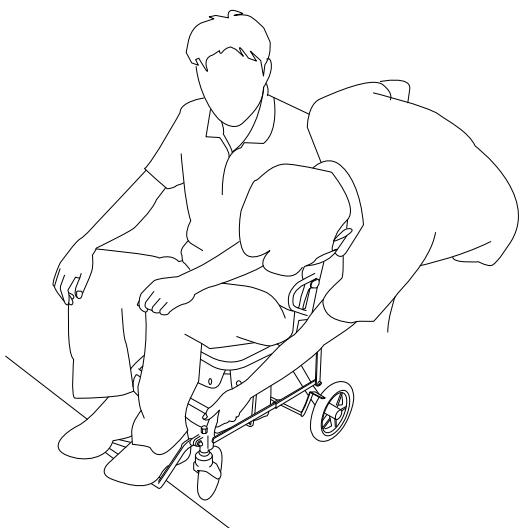
前輪を持ち上げて段差を乗り越えてください。または、後向きで後輪を持ち上げて段差を乗り越えてください。
