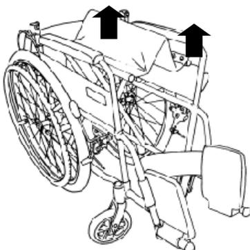
座シート前方と後方の中央部を同時に持ち上げます。
