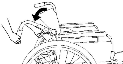
押手を握り、一方の手で背折れ金具のレバーを後方へ引きながら（もしくは前方へ倒しながら）押手を倒します。また、反対側も同様に倒してください。
