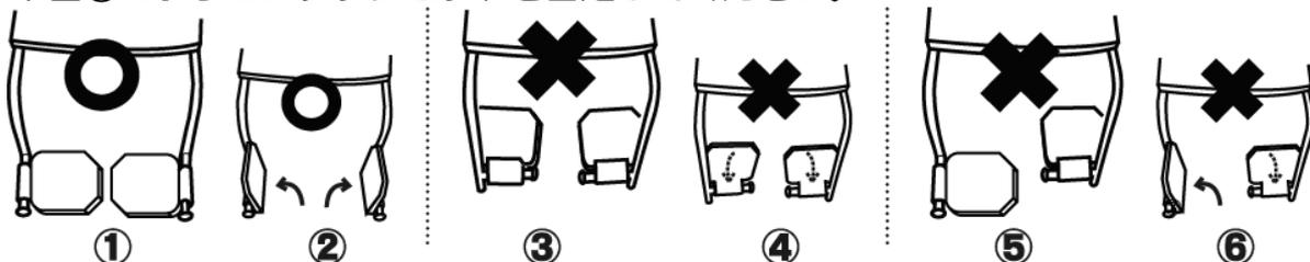
※車いすを折りたたむ時は下図②のようにステップ板を跳ね上げてください。
