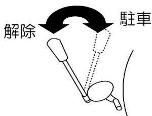
ブレーキレバーを後方に引くとロックし、レバーを前方に倒すと解除されます。
