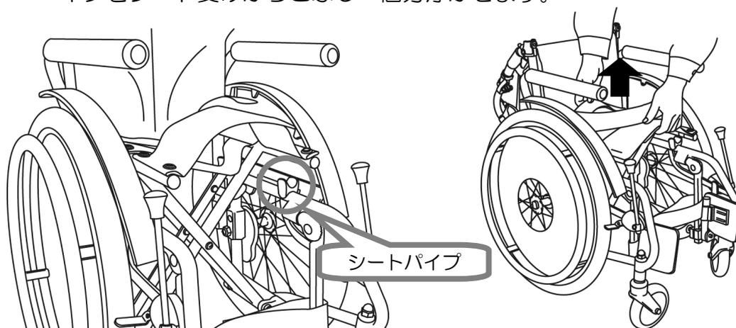
②-3 シートパイプの先端部を抜き取ります。
