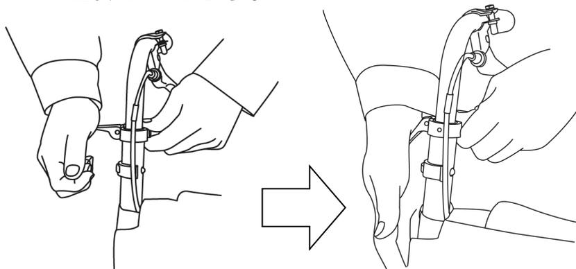
⑥押手固定 E ピンを差し込み、押手を固定します。
