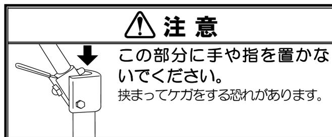
押手を握り、一方の手で背折れ金具のレバーを後方へ引きながら（もしくは前方へ倒しながら）押手を倒します。また、反対側も同様に倒してください。
