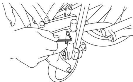
付属品の 4 mm 六角 L レンチを使って、ステップ板の裏側のボルトを緩め、適当な高さに合わせた後、ボルトを完全に締めてください。
