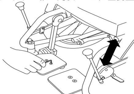
付属品の 4 mm 六角 L レンチを使って、ステップ板の表側のボルトを緩め、適当な位置に合わせた後、ボルトを完全に締めてください。
