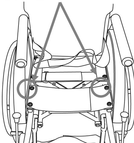
②-2 座ベース前シート前方と後方の中央部を同時に引き上げ、クロス金具のシートパイプをシート受けからこぶし一個分浮かせます。
