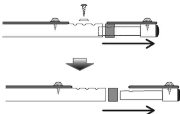
③奥行調整用パイプの入れ込み個数で、シート奥行きを調整します。
