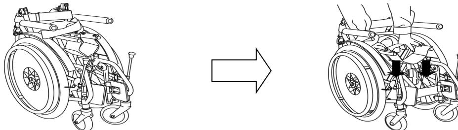
駐車ブレーキをかけ、車いすの後方か前方に立ち、シートパイプ部分を上から手で少し押し下げます。
