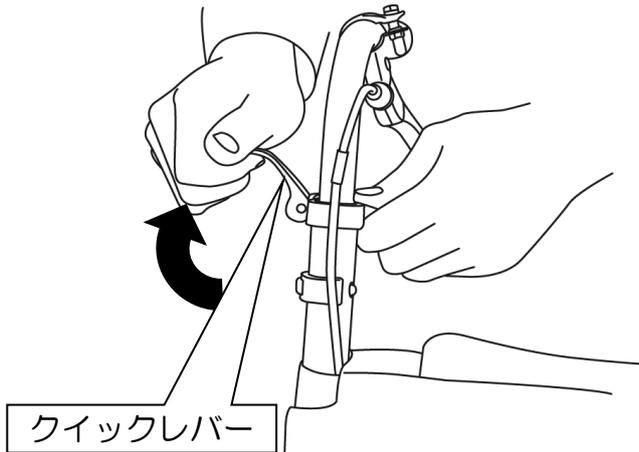
片手でクイックレバーを、もう片方の手でクイックレバーの反対側をしっかりとにぎり、クイックレバーを引き上げてください。
