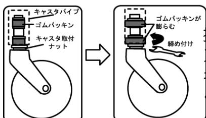
(出荷時には充分に締め付けてあります、ご使用されている間に振動により緩む場合がありますので、定期的に点検してください。)スパナでキャスター取付ナットを締めると、ゴムパッキンが膨らみ、キャスターが固定されます。キャスター取付ナットをしっかりと締めてください。締付が弱いとキャスターが外れる恐れがあります。
