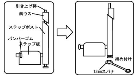
●ステップセット先端六角ボルト部分をスパナでしっかりと締め付けてください。締めることにより斜ウスがズレてステップセットが固定されます。締付が弱いとステップセットが外れる恐れがあります。しっかりと固定されている事を確認してご使用ください。
