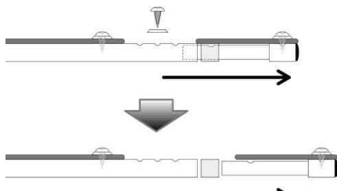
④ シートパイプの先端部を抜き取ります。
