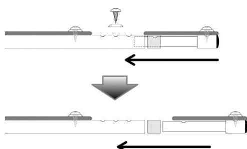
⑥ 抜き取ったシートパイプの先端を、シートパイプ本体に戻し、穴位置を合わせ、ねじを締めて固定します。
