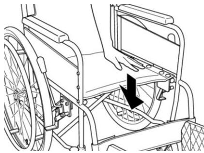
②片方のフレームを持ち上げて車輪を少し地面から浮かせ、座面端のパイプ部分を上から手で押し下げます。
