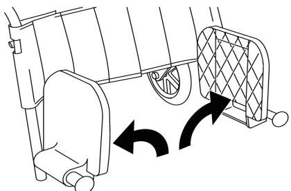
4. ノブ玉を持ち、上方向に引き上げてちぢみ止めを解除します。
