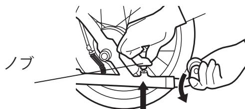
3. ノブから手を離して転倒防止金具が固定されていることを確認します。
